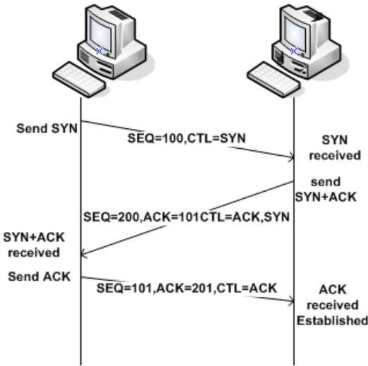
Fig. 7. TCP 3-way handshaking
