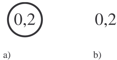
Joonis 2. Suhtvea ja taandvea kujutamine mõõteriistadel. a) suhtviga \delta = 0,2\% . b) taandviga \gamma = 0,2\% .
